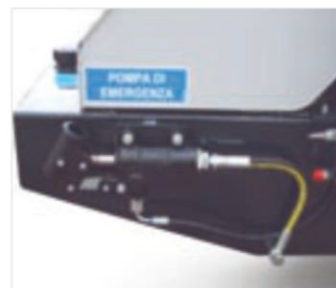
Snadno přístupné a ovladatelné manuální nouzové spouštěcí zařízení
