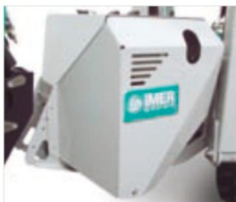
Prostor pro motor navržený tak, aby zajistil co nejlepší zvukotěsnost
